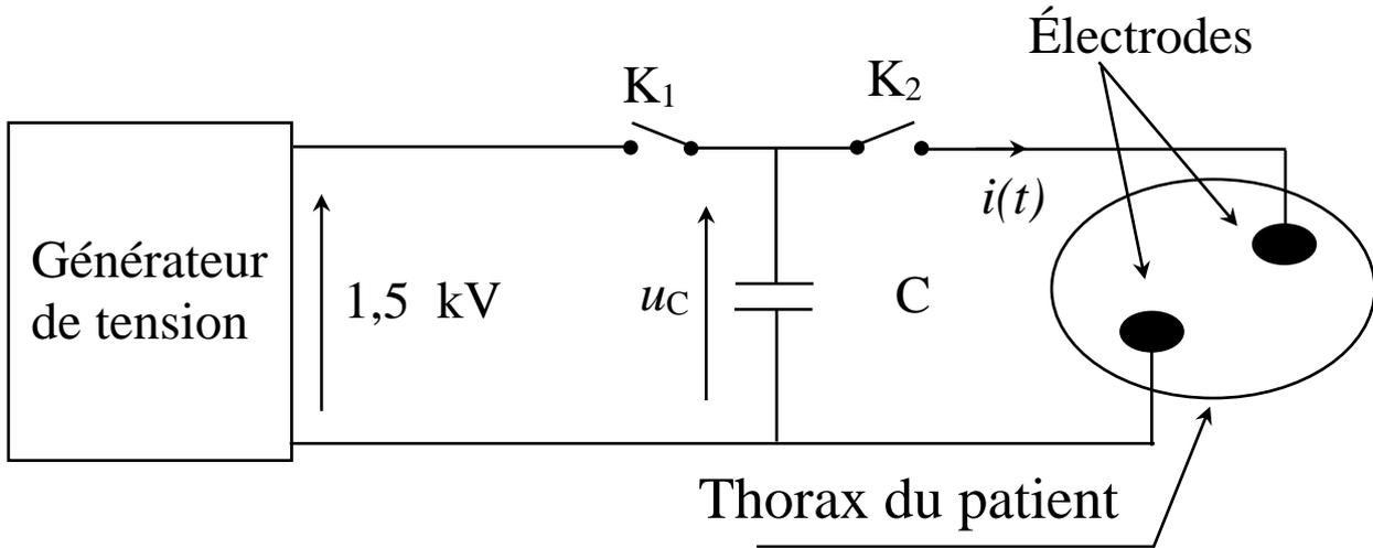
La capacité du condensateur  $C$  est de  $470 \mu F$ .
